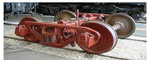
Un **bogie** (ou **boggie**) est un chariot situé sous un véhicule ferroviaire, sur lequel sont fixés les essieux (et donc les roues). Il est mobile par rapport au châssis du véhicule (locomotive, wagon ou voiture) et destiné à s'orienter convenablement dans les courbes.
